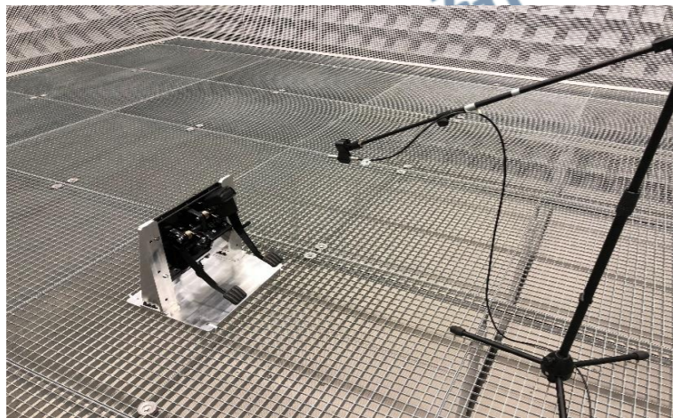
刹车踏板工作噪声测试照片
