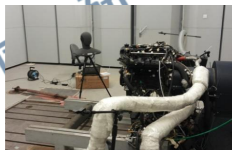
发动机半消试验室 (带电力测功机)
